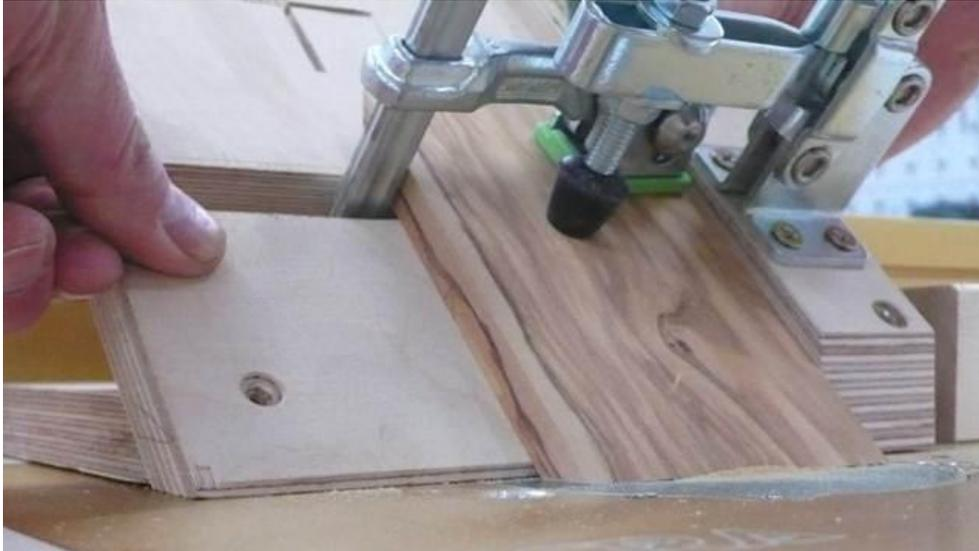
Abb. 7: Jig zum Fräsen der Nuten für die lose Feder
