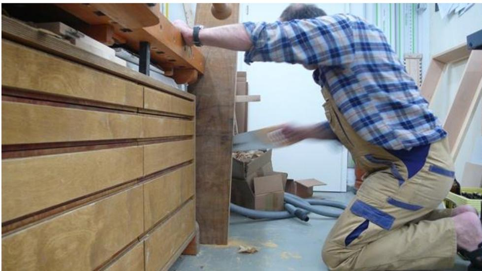
Abb. 4: Auftrennen der Bohle von Hand 2
