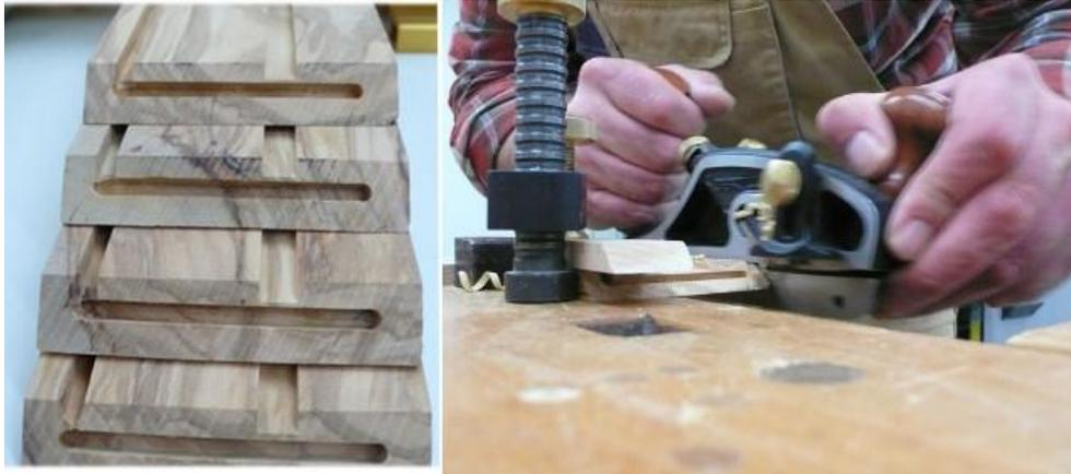
Abb. 9: Nuten – gefräst bzw. gehobelt
