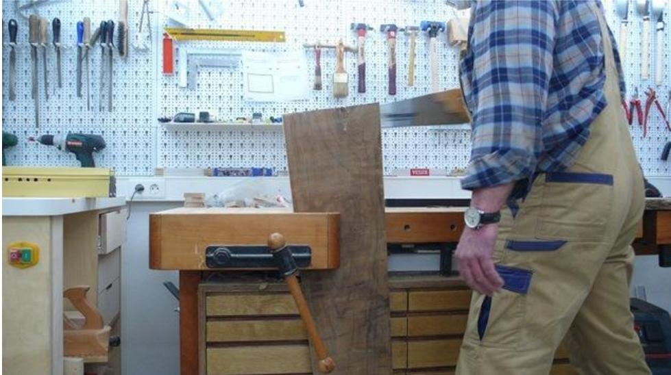
Abb. 3: Auftrennen der Bohle von Hand 1
