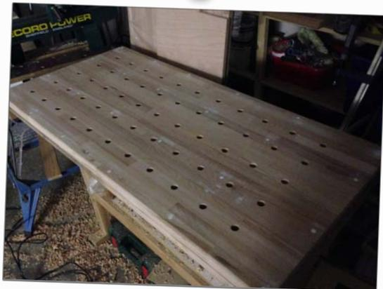
Alle Löcher bohren und den Tisch abschleifen.
