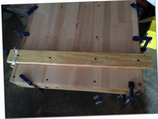
Mit Hilfe einer Bohrlehre können immer gleiche Abstände gebohrt werden
